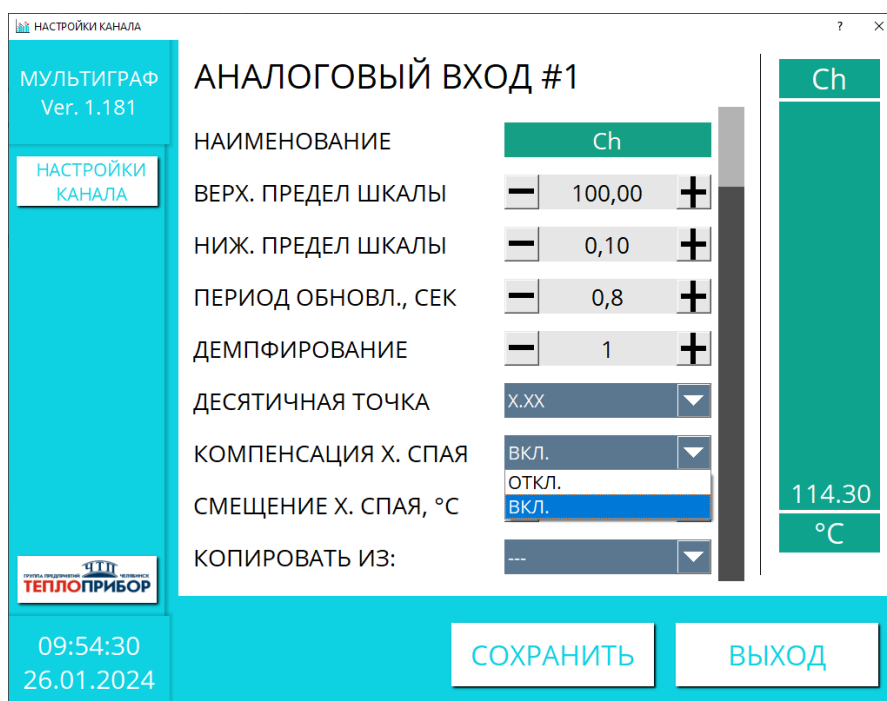
Рисунок 2.16 – Компенсация холодного спая
