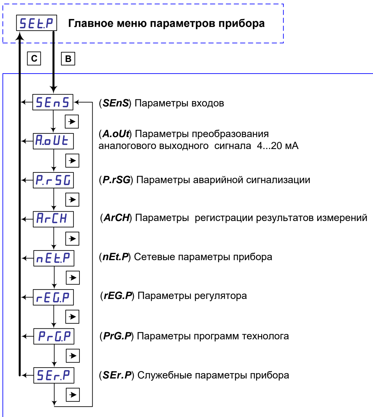
Рисунок 27 – Схема выбора групп рабочих параметров прибора.
