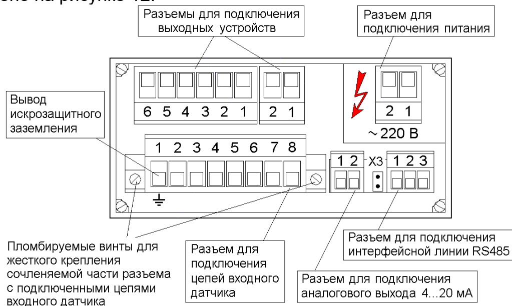
Рисунок 12 – Вид прибора со стороны подключения внешних цепей
