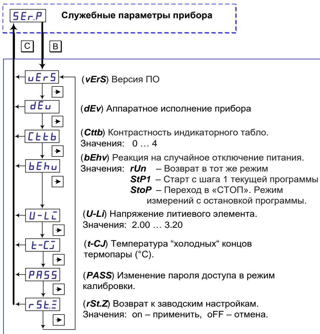
Рисунок 37 – Схема просмотра и задания служебных параметров прибора.
