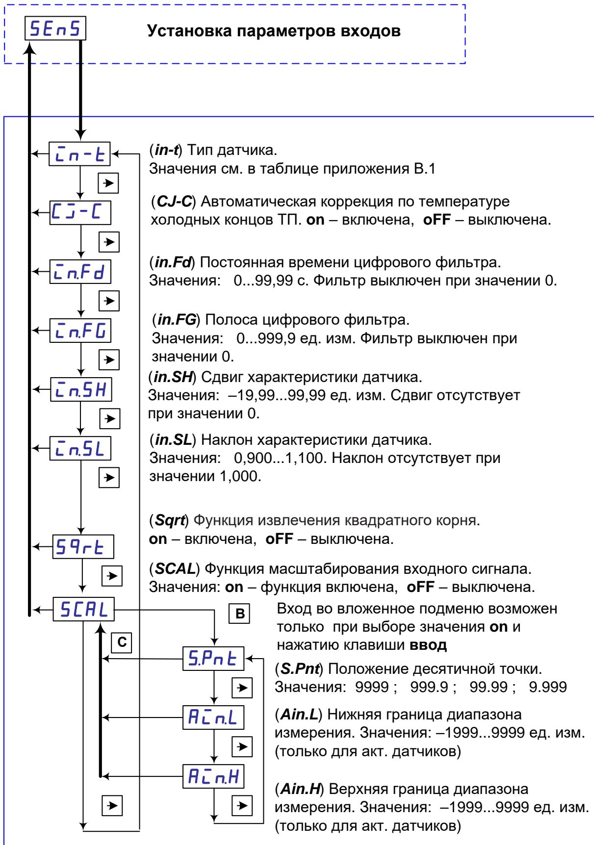
Рисунок 28 – Схема задания параметров входов.
